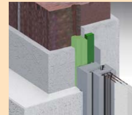
• Außen: WDVS-Band • Mitte: Schaum • Innen: TP670, optional Verleisten
